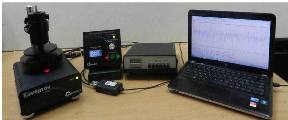
Рис. 3. Зовнішній вигляд випробувально-вимірювального комплексу вхідного контролю шарикопідшипників
