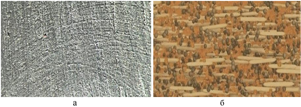
Рис. 2 – Фотографія поверхні (а) та структура (б) матеріалів ZX-324VMT та Iglidur.
