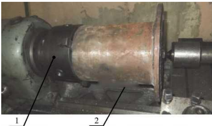
Рис. 5. Оснащення для зміцнення конічних шестерень на токарному верстаті шляхом динамічного наклепу поверхонь зубів сталевими кульками та порошком фторованого графіту: 1 - патрон токарного верстата; 2 - робоча ємність
