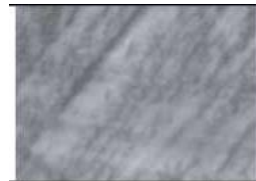
Рис. 9. Профілограма поверхні зуба конічної шестерні до зміцнення ( Ra = 0,76 мкм) x400
