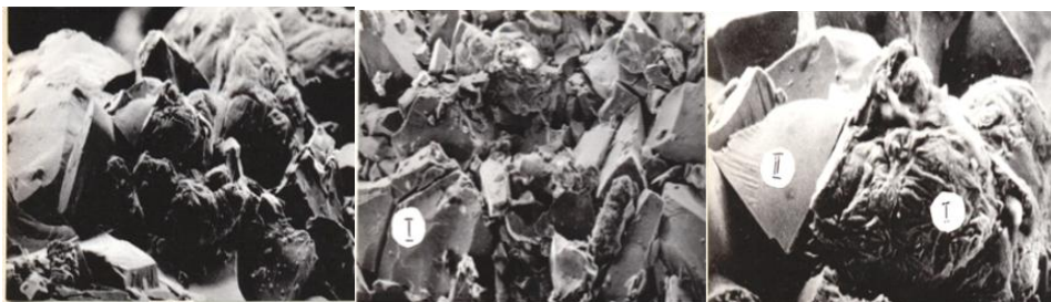
Рис. 2. Фрактограми покриття (x500), отриманого електроконтактним припиканням шихти з 60% ПГ-С1 та 40% ФХ-800 (1-ділянка руйнування частинок ФХ-800)
