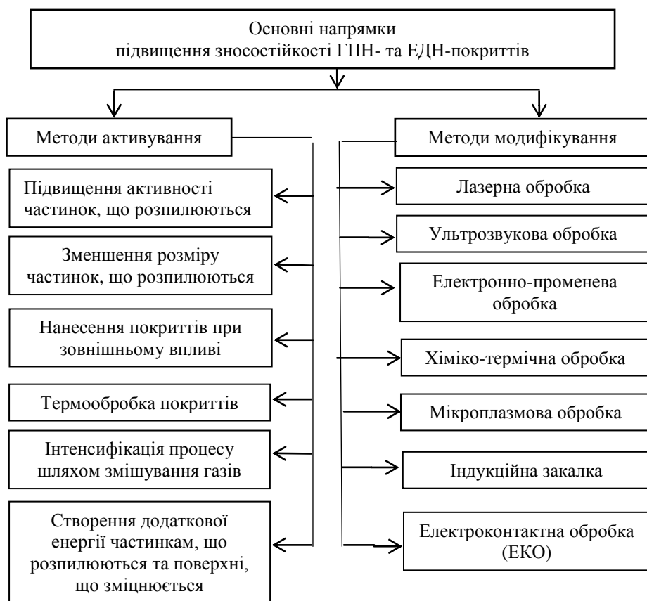
Рис. 1. Основні напрямки підвищення зносостійкості газополумєневих і електродугових покриттів
