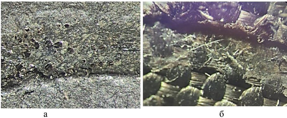
Рис. 3 – Топографії поверхонь тертя матеріалів: металополімерної стрічки (а), Fluroglide (б), після випробувань в умовах вібраційних навантажень. Умови випробувань (А-500 мкм, v – 3 Гц, Р – 10 МПа, N – 10^5 циклів, T – 293 K).
