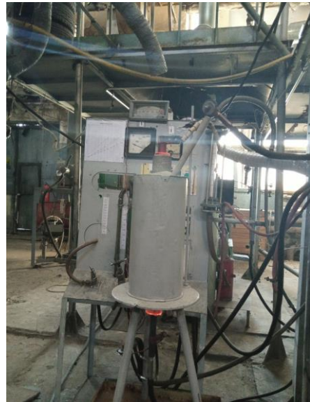
Рис. 6. Зовнішній вигляд реактору ЕТПШ з комбінованим способом нагрівання
