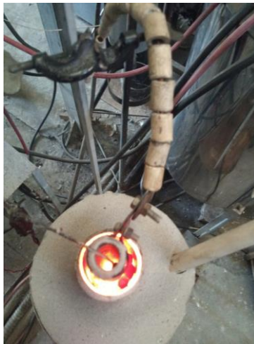
Рис. 8. Зовнішній вигляд верхньої частини установки з ЕТПШ під час процесу відновлення залізних окатишей ( T \approx 1173 K)
