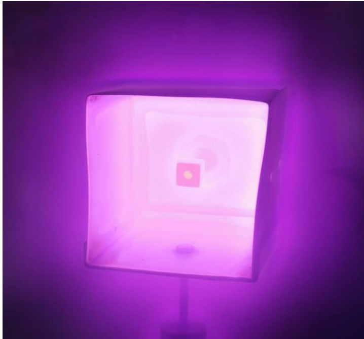
Рис. 1. Фото тліючого розряду в порожнистому катоді при азотуванні зразка, що знаходиться в центрі катоду.
