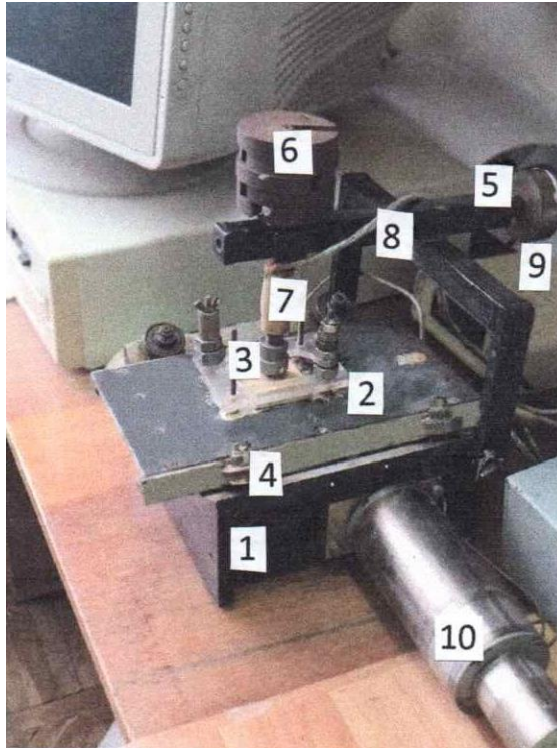
Рис. 3. Установка для трибологічних досліджень за умов зворотно-поступального руху: 1 – станина; 2 – столик; 3 – пара тертя «деревина-сталь 9ХС з ЕПП»; 4 – підшипники; 5 – горизонтальний рівень; 6 – навантаження; 7 – вертикальне коромисло; 8 – горизонтальна балка; 9 – вертикальний рівень; 10 – двигун
