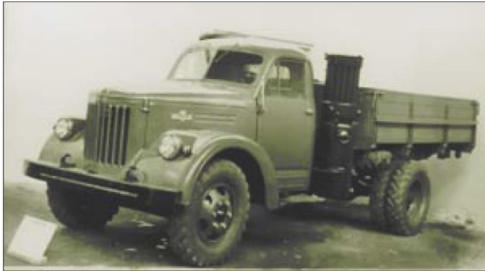
Рис. 1. Вантажний автомобіль «Уралзіс» з вмонтованим газогенератором для роботи на піролізному газі, перша половина 1940-их рр.
