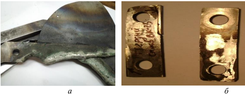
Рис. 5. Загальний вигляд наплавлених деталей: а - ножі для різання квітів, б - молотки млина для виготовлення ліків.
