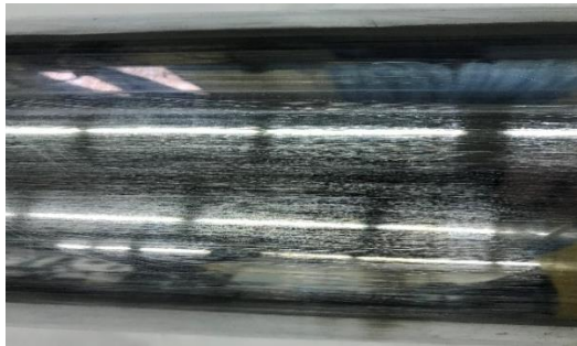
Рис. 1. Пошкодження штоку амортизаційної стойки основного шасі літака Ан-32 у результаті абразивного зношування
