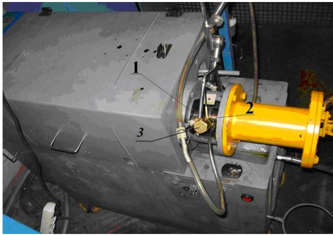
Рис. 1. Кінематична схема контакту «кільце-кільце»: 1 – рухоме кільце; 2 – нерухоме кільце; 3 – датчик акустичної емісії
