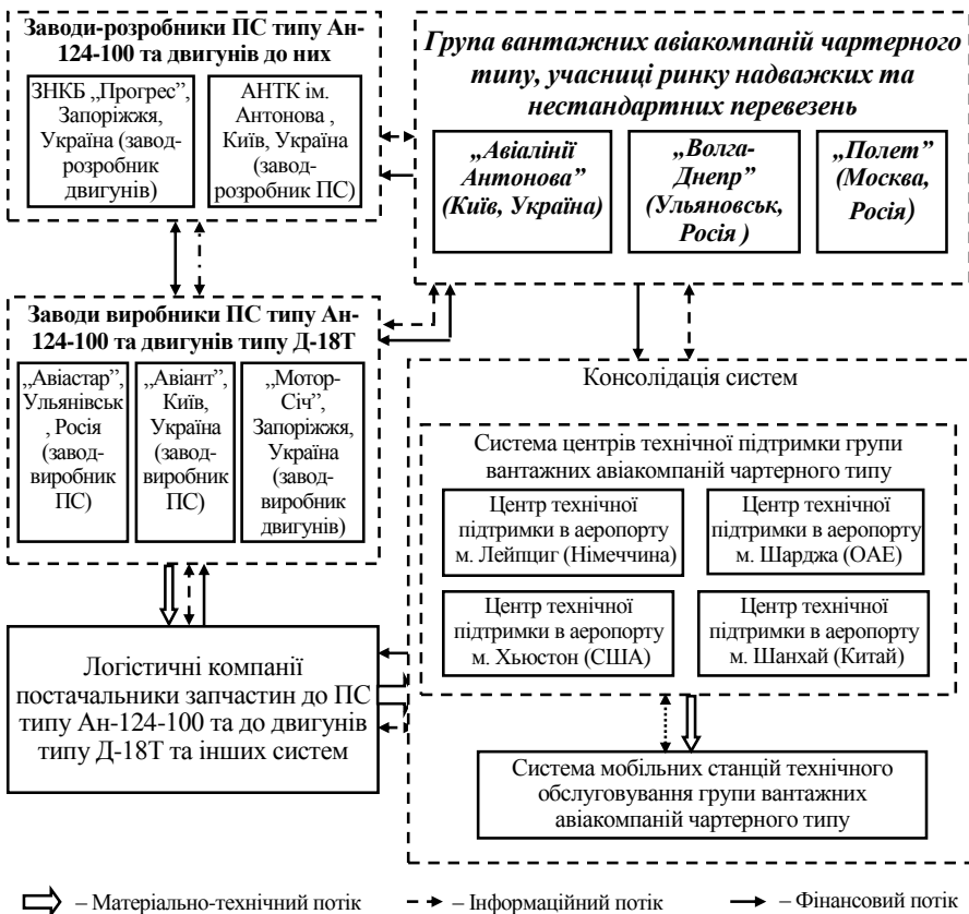
Рис. 1 Рекомендована схема взаємодії групи вантажних авіакомпаній чартерного типу, інших учасників процесу технічного обслуговування ПС та систем центрів технічної підтримки та мобільних станцій технічного обслуговування
