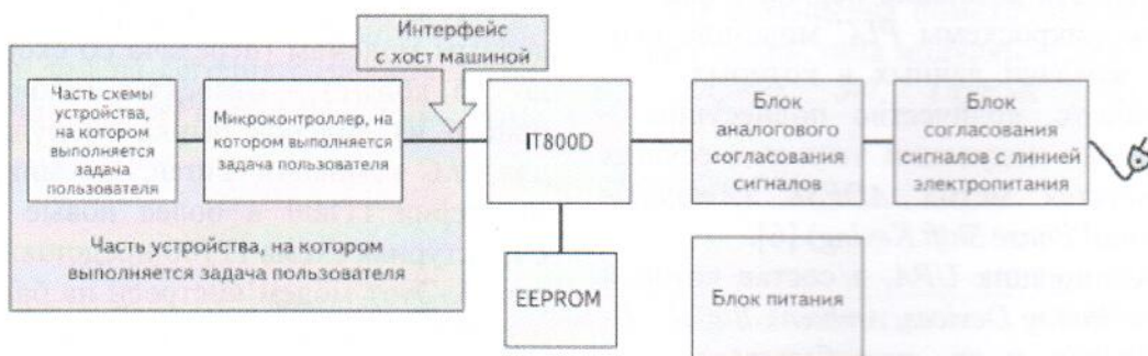
Рис. 3. Блок-схема модуля, в состав которого входит PLC модем
