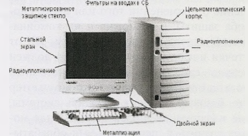
Рис.3. Технология защиты ПК от ПЭМИ
