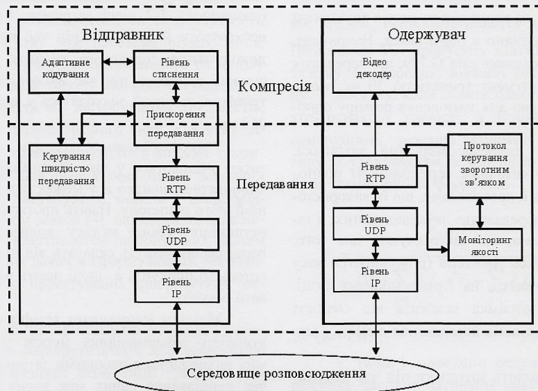
Рис. 1. Схема застосування набору протоколів RTP/UDP/IP для передавання мультимедійних даних
