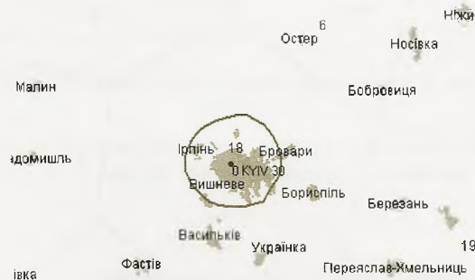
Рис. 2. Теоретична зона впевненого прийому для мобільного прийому основної РЕЗ ЦНТВМ в м. Києві
