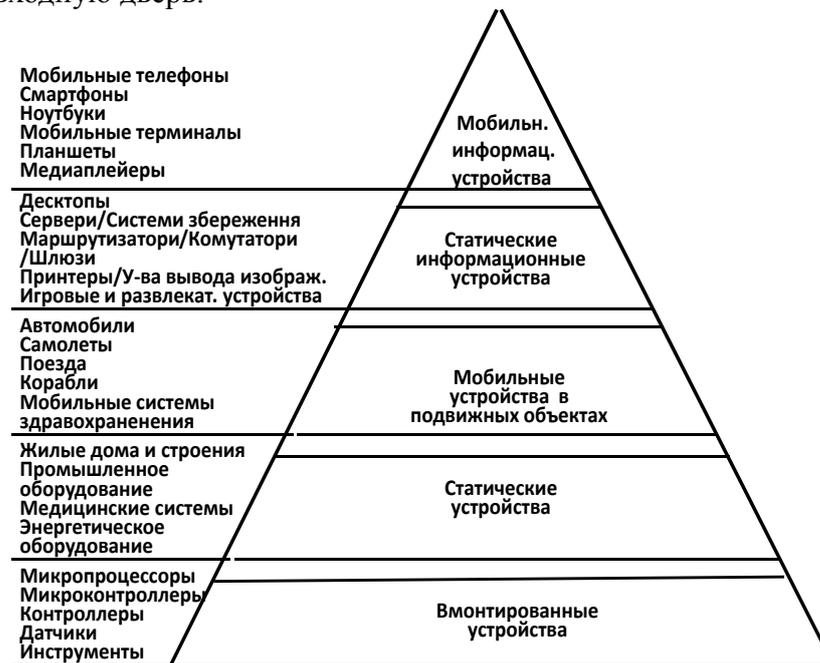
Рис. 3. Иерархическая структура устройств, используемых для подключения объектов в IoT и WoT
