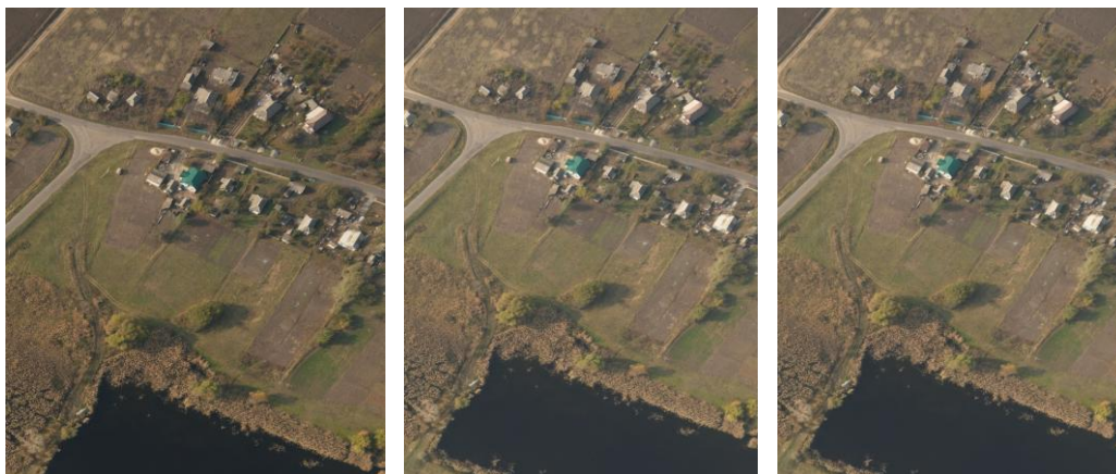
Рис.2 Порівняння стиснутих зображень: а – оригінал зображення (41Мб), б – стиснення вейвлет-методом (5.31 Мб), в – стиснення запропонованим методом (3.8Мб). Міра відношення сигнал до шуму складала: PSNR=35.3 dB
