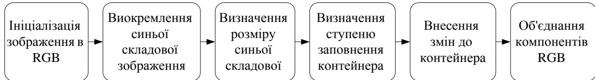
Рис. 9. Структурна схема реалізації приховування інформації в компоненту синього кольору
