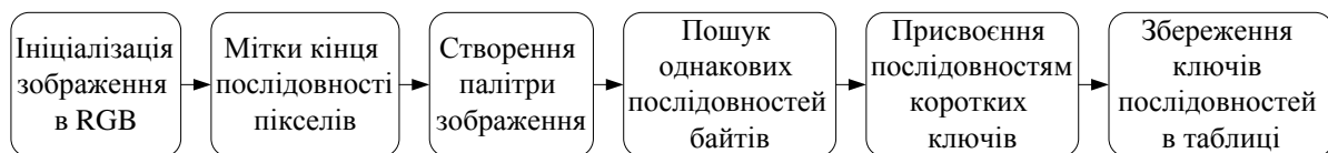
Рис. 4. Структурна схема реалізації алгоритму LZW
