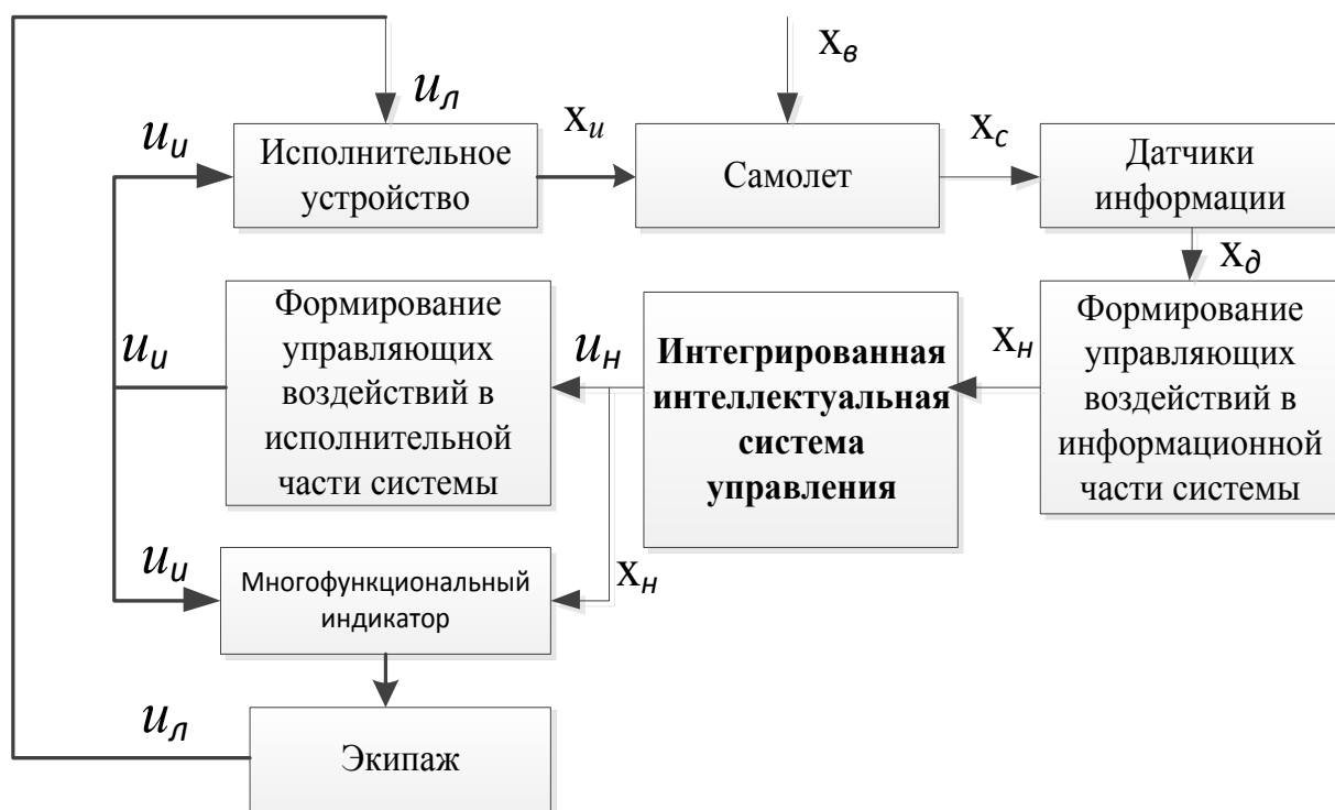
Рис. 3. Структурная схема системы «самолет – экипаж – среда- интеллектуальная интегрированная система управления– среда» в особой ситуации в полете.
