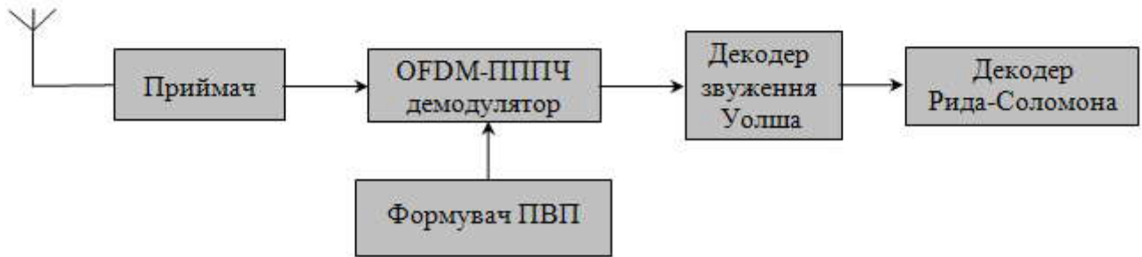
Рис. 2. Структурна схема архітектури прийому системи OFDM, з внутрібітовою ПППЧ та кодами Ріда-Соломона
