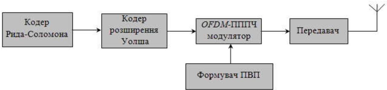
Рис. 1. Структурна схема архітектури передачі системи OFDM, з внутрібітовою ПППЧ та кодами Ріда-Соломона
