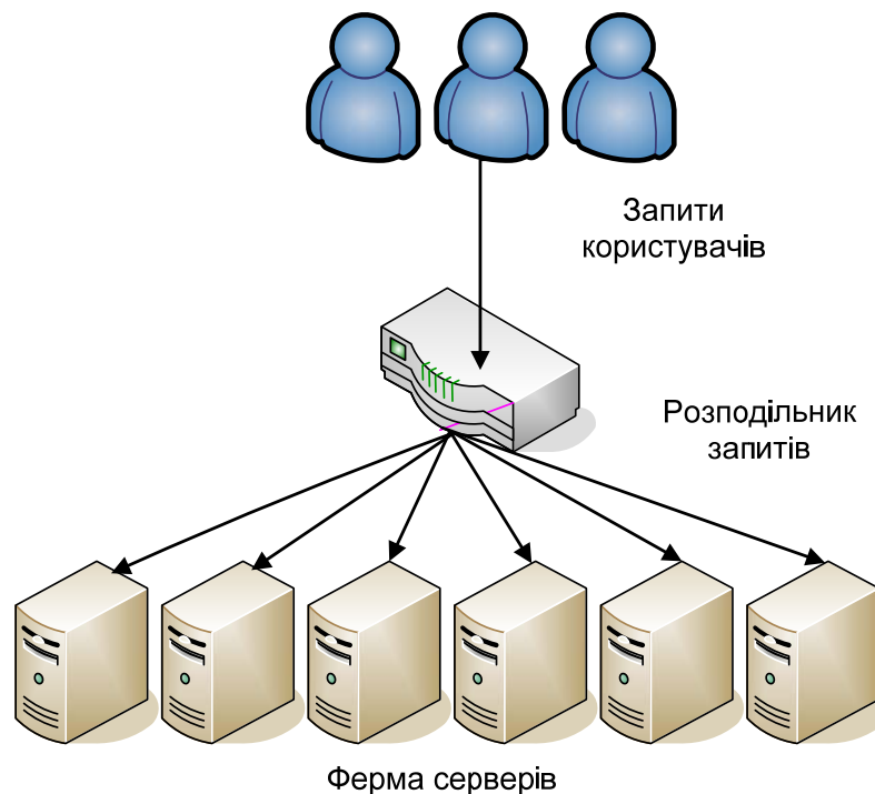
Рис. 2. Кластер балансування навантаження
