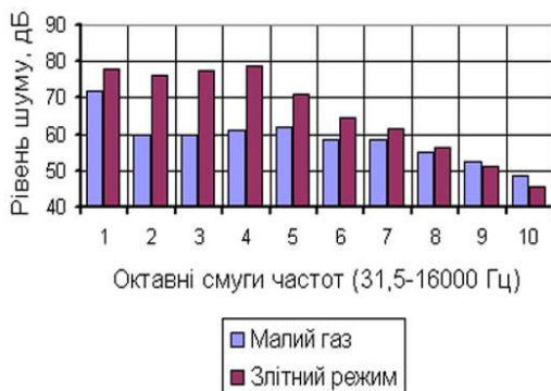
Рис. 1. Спектрограма шуму на режимах малий газ та злітний
