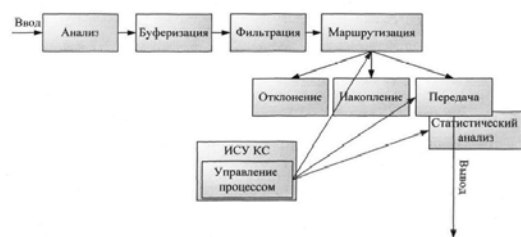
Рис. 3. Функциональная схема сегмента ККС
