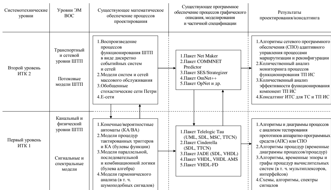
Рис. 2. Двухуровневая архитектура программных сред инструментально-технологических комплексов интеллектуального проектирования
