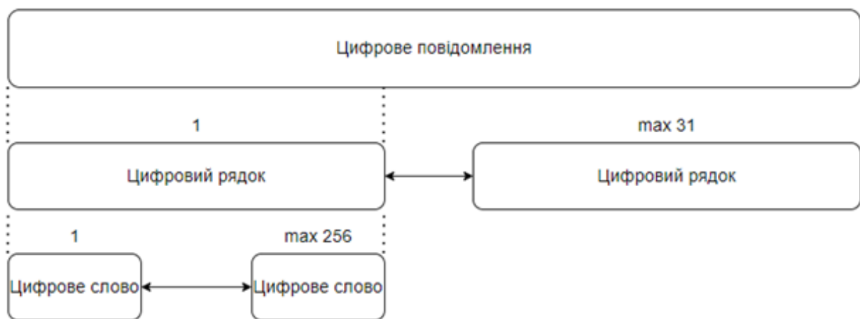
Рис. 3. Структура пакету повідомлень ARINC-629
