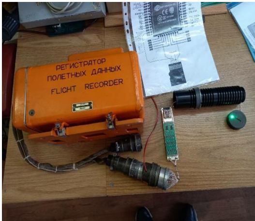
Рис. 11. Зчитування польотної інформації з реєстратора 2ТЗМ за допомогою розробленого «БІФ-4Т»
