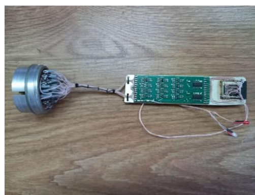
Рис. 4. Плата нормалізації сигналів «БІФ-4Т», з підключеним модулем Wi-Fi .
