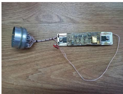
Рис. 6. Плата «БІФ-4Т» для управляючих напруг сигналів: пуск, зупинка, реверс праворуч/ліворуч, зворотне зчитування
