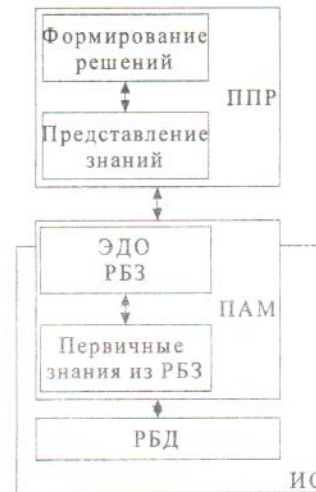
Рис. 3. Обобщенная функциональная структура интеллектуальной системы управления
