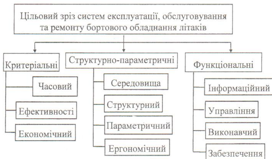
Рис. 2. Класифікація цільових зрізів системи експлуатації, обслуговування та ремонту бортового обладнання літаків
