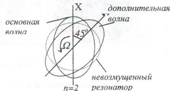
Рис. 2. Возбуждение упругих волн в резонаторе КВГ
