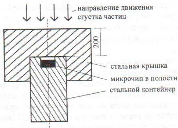
Рис. 1. Схема контейнера для импульсных испытаний электронных микросхем в условиях сверхглубокого проникания
