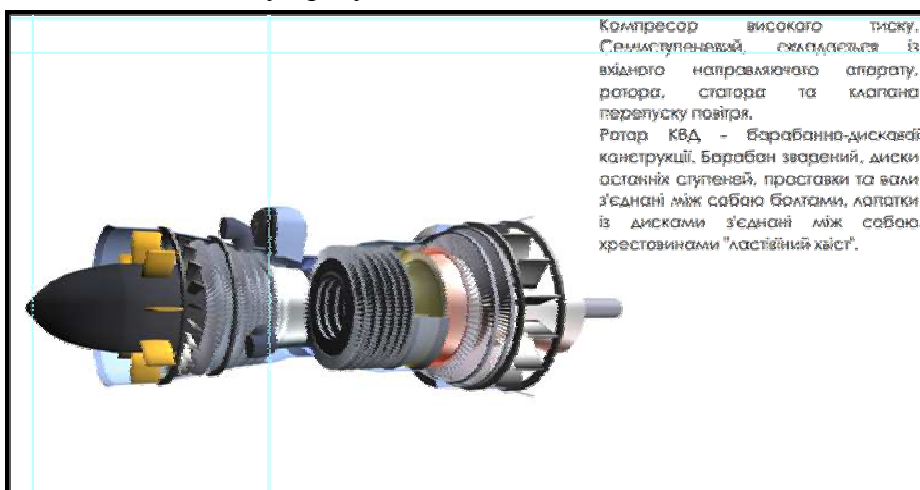
Рис. 7. Фрагмент 3D-моделі двигуна з текстовим поясненням
