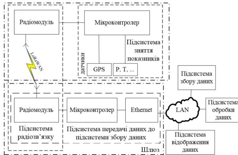
Рис. 4. Схема макетного зразка системи моніторингу
