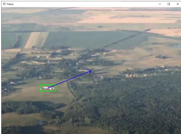
Рис. 2. Результат роботи трекінгу з вектором відхилення цілі від центру кадру
