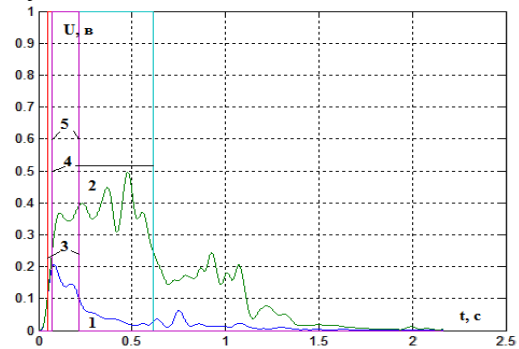
Рис.6. Результаты численного исследования Образца звука разбития стекла 1.Огибающая сигнала на выходе низкочастотного канала. 2. Огибающая сигнала на выходе высокочастотного канала. 3.Импульс блока сравнения низкочастотного канала. 4. Импульс блока сравнения высокочастотного канала. 5. Импульс блока совпадения.
