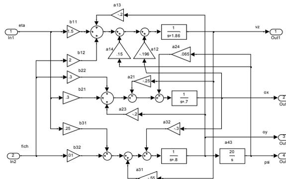
Рис.3. Структурная схема модели бокового канала вертолета
