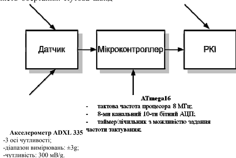
Рис. 2. Структурна схема приладу
