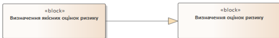
Рис. 3. Відношення узагальнення між батьківським блоком "Визначення оцінок ризику" та блоком-нащадком "Визначення якісних оцінок ризику"
