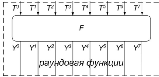
Рис. 4. Схема раундовой функции сети RFWKIDEA16-1
