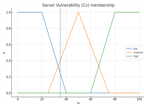
Рис. 2. Функція належності від параметрів вразливості серверів
