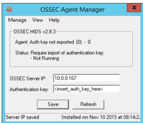
Рис. 12. Вікно OSSEC Agent Manager для введення IP-адреси менеджера
