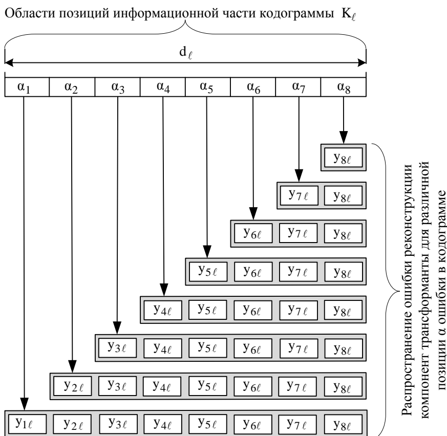
Рис. 5. Влияние позиции искаженного бита информационной части кодограммы на количество восстановленных с ошибкой компонент трансформанты
