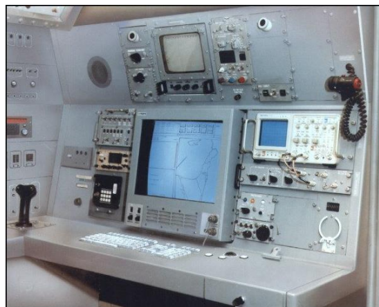
Рис. 2. EL/L-8300 SIGnals INTelligence System, що охоплює діапазон частот від 0,03 до 40 ГГц
