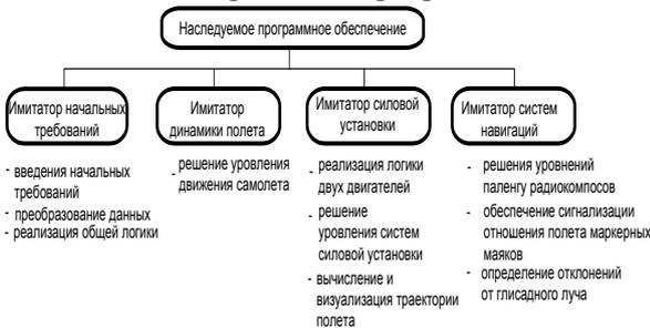
Рис. 10 Состав программного обеспечения
