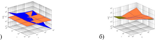
Рис. 2 Залежність e_{min} від конструктивних (а) та експлуатаційних (б) параметрів для вінерівського (класичного) та нового функціоналів.
