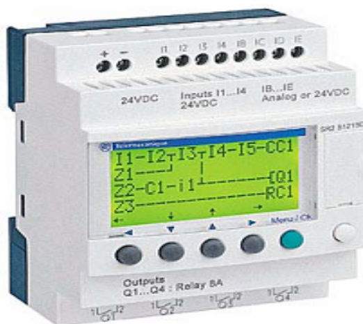
Рис. 1. Миниатюрный ПЛК – интеллектуальное реле фирмы Schneider Electric, Франция
