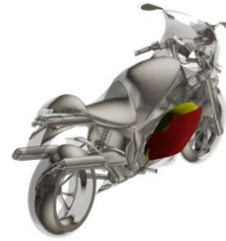
Рис. 3. Применение в построении модели мотоцикла вспомогательных материалов для доводки формы.
