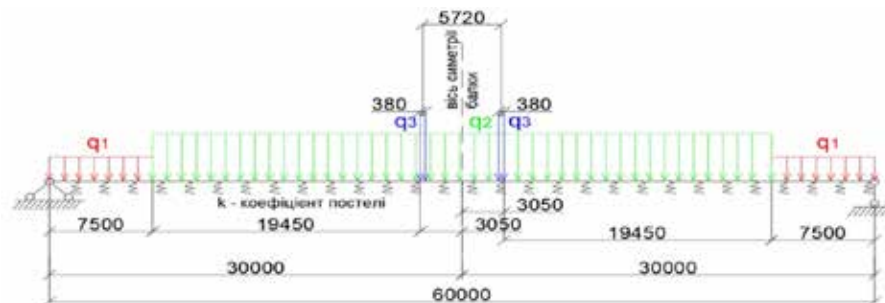
Рис. 2. Розрахункова схема балки-обойми скінченної довжини на пружній основі, схема навантаження та граничні умов Джерело: розроблено автором.
